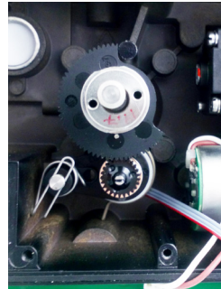
Potentiomètre et roue dentée pour une rotation de 90
