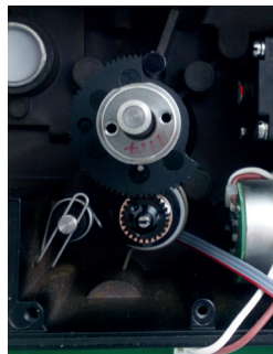
Potentiometer och kugghjul för 90° rotation
