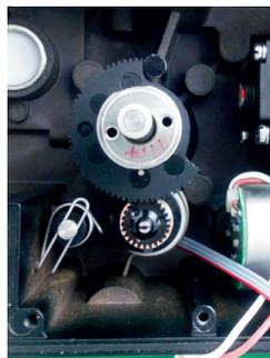
Potenzimetro e ruota dentata per rotazione di 90°
