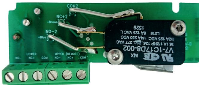
Durante l'installazione della scheda switch, assicurarsi che sia posizionata correttamente. Fissare il circuito stampato con due viti. Assicurarsi che i fori siano centrati prima di serrare le viti.
