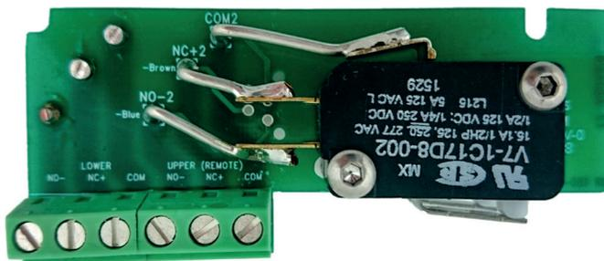
Lors de l'installation de la carte de contacteur, assurez-vous qu'elle est correctement positionnée. Fixez la carte PC avec les deux vis. Assurez-vous que les trous sont centrés avant de serrer les vis.
