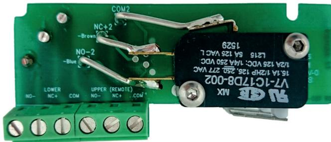
在安装开关板时，确保其放置正确。使用两颗螺丝固定 PC 板。先确保螺丝孔居中，再拧紧螺丝。
