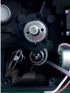
90° dönüş için potansiyometre ve dişli çark
