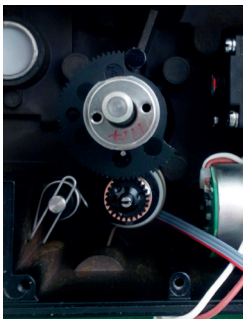
Potentiometer und Zahnrad für 90°-Drehung
