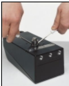
Spindeländen byts enkelt med hjälp av två skruvmejslar
