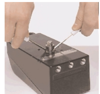
Wymiana trzpienia przy użyciu dwóch wkrętek
